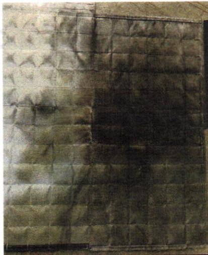
Decke nach dem Test mit einem »Thermal Runaway« einer 18 650er-Zelle
